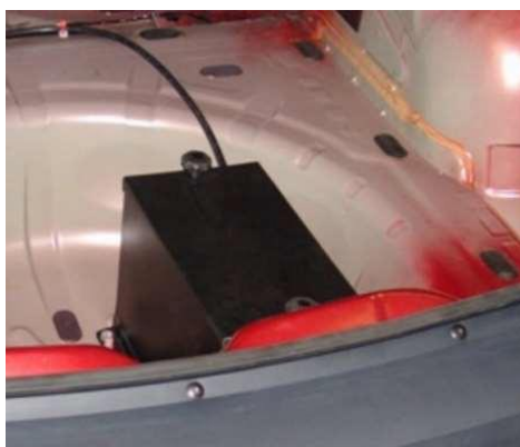
2.7. Montarea bateriei în locașul roții de rezervă
