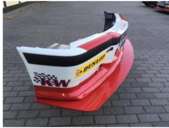
Bară de protecție față cu splitter
